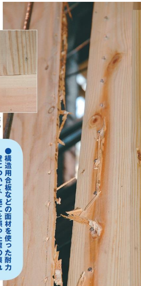
上は実験前の試験体の様子。 5mmもめり込んでいるため、くぎ 頭が見えにくい。右は実験後の 様子
