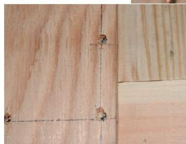
上は実験前の試験体の様子。 5mmもめり込んでいるため、くぎ 頭が見えにくい。右は実験後の 様子
